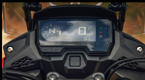
Cuenta con velocímetro, cuentarrevoluciones, dos odómetros, nivel y consumo de combustible
